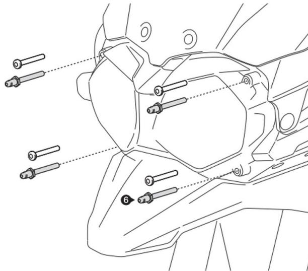
4. Insérer l'ensemble de protection dans les pitons, aussi profond que possible.
