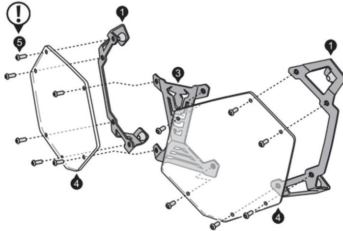
3. Démontez les vis de phares de la moto. Montez à leur place des pitons de fixation (6), mettez de la colle de filetage par sécurité.
