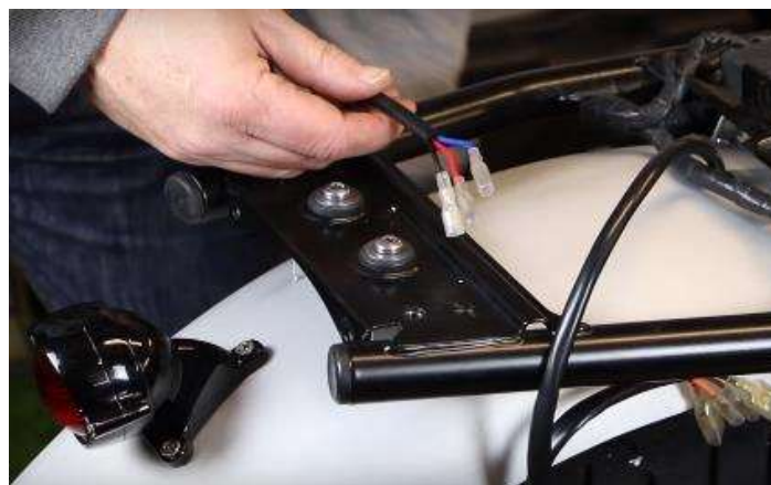
Connecter sur le feu (sous le g-boue) Connect onto the light (under the fender)
