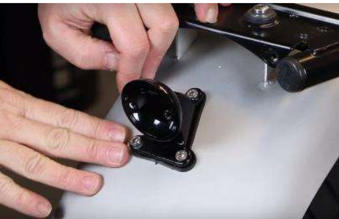
Monter la base du feu (3 vis) Fit the light base (3 bolts)
